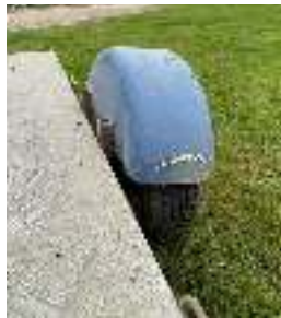
Garde-boue réalisée avec des fûts
