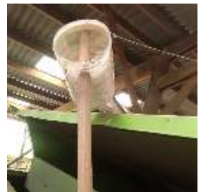
Perche de prélèvement d'échantillons en céréales
